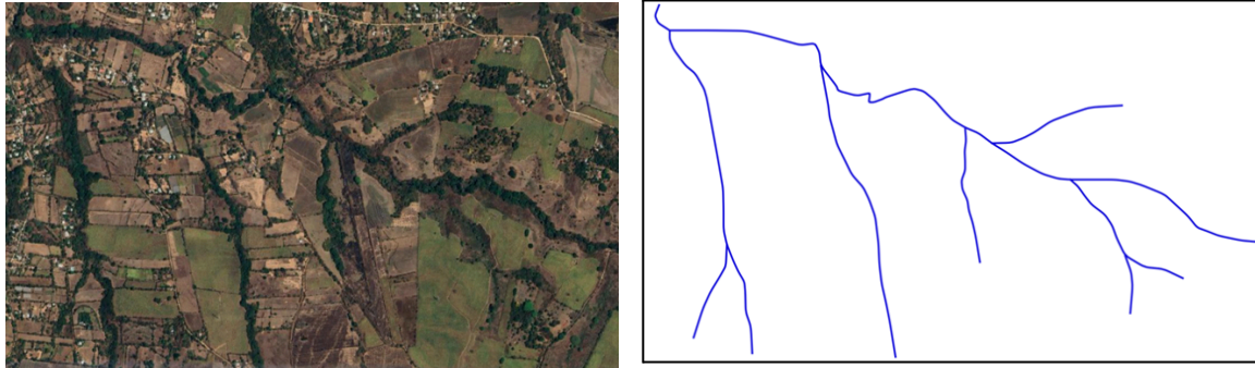
Figura 53. Visión de ejemplo de una vectorización de cadenas de líneas sobre ríos.
